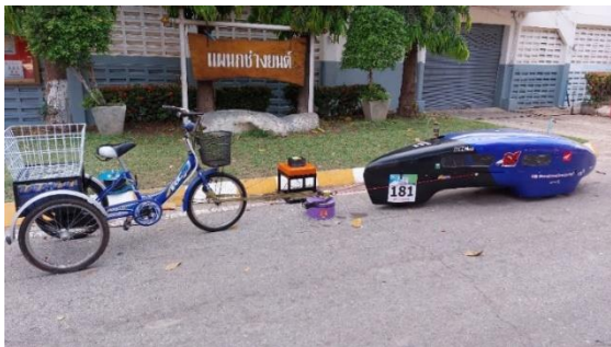
ภาพที่ 7 การทดลองแรงจุดลากรถประหยัดน้ำมัน เชื้อเพลิงบนพื้นถนนยางมะตอย
