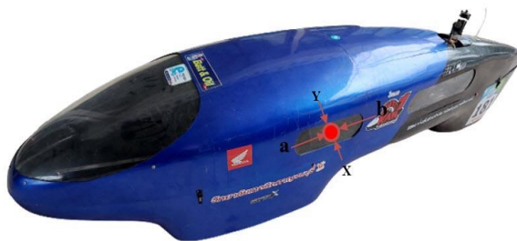
ภาพที่ 12 แสดงตำแหน่งจุดศูนย์ถ่วงของรถ ประหยัดน้ำมันเชื้อเพลิงกึ่งอัตโนมัติ
