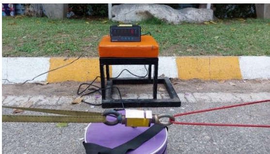
ภาพที่ 8 โหลดเซลล์ที่ใช้ในการทดลองหาแรงจุดลากร
