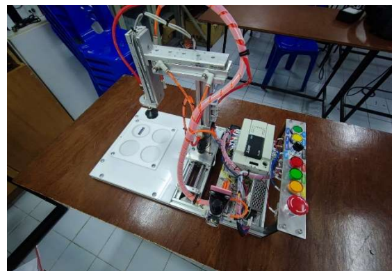
ภาพที่ 2 เตรียมอุปกรณ์และเครื่องมือถอดและประกอบชุดทดลองเคลื่อนย้ายวัตถุทำงานด้วยโปรแกรมเมเบิลคอนโทรลเลอร์
