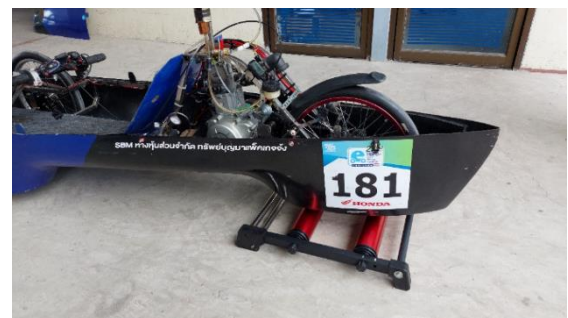
ภาพที่ 9 แสดงการติดตั้งแท่นปั่นรถจักรยานที่ล้อ หลังรถประหยัดน้ำมันเชื้อเพลิง
