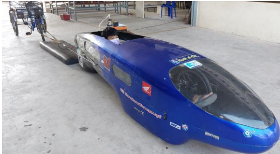
ภาพที่ 6 ทดลองแรงจุดลากรถประหยัดน้ำมัน เชื้อเพลิงบนพื้นปูนขัดมัน
